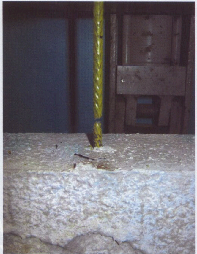
Particolare della rottura della barra da 6 mm.
